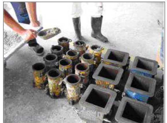
รูปที่ 22 การเก็บก้อนตัวอย่างทรงกระบอกขนาดเล็ก ( \varnothing 100 \times 200 mm.)
