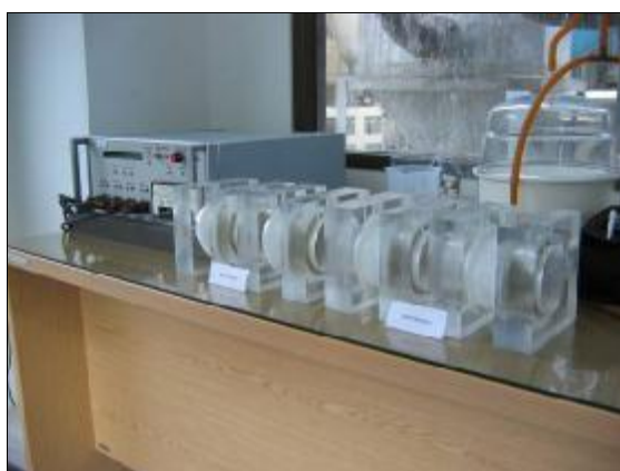
รูปที่ 25 การทดสอบ Chloride Charged Passed ก่อนตัวอย่างเป็นเวลา 6 ชั่วโมง
