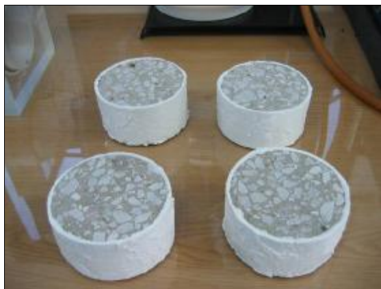
รูปที่ 23 การเตรียมก้อนตัวอย่างความหนา 2" เพื่อรอทดสอบ Chloride Charged Passed
