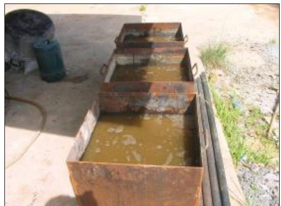
5.6 ชุดที่ 3 นำไปแช่ในน้ำทิ้งที่อุณหภูมิ 90 องศาเซลเซียส
