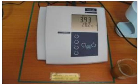
ภาพที่ 4 ผลการทดสอบ PH และ Acid Value น้ำมันปาล์มดิบ
