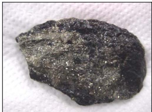
รูปที่ 7 แสดงตัวอย่างหินที่มีแร่ไพไรต์เจือปนอย่างชัดเจน ก่อนและหลังการทดสอบ
