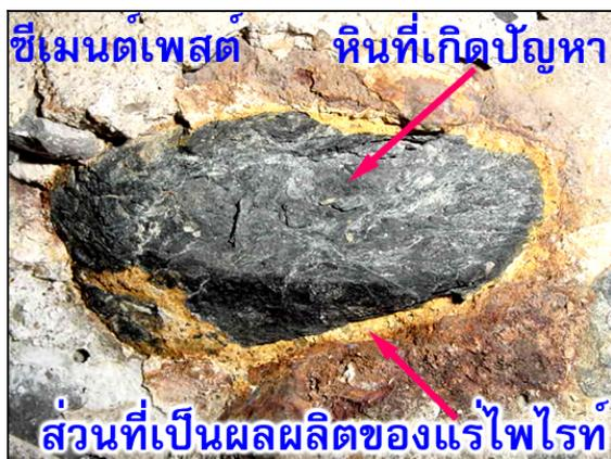
รูปที่ 8 แสดงรูปตัวอย่างคอนกรีตที่มีปัญหาก่อนนำไปทดสอบ
