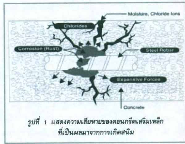
รูปที่ 1 แสดงความเสียหายของคอนกรีตเสริมเหล็กที่เป็นผลมาจากการเกิดสนิม
