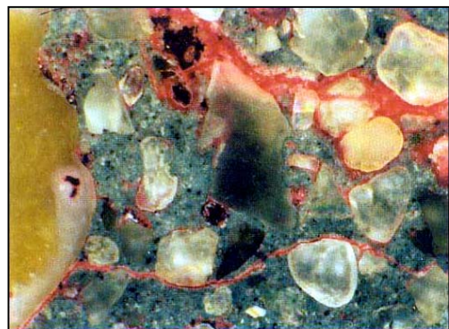
รูปที่ 3 ภาพถ่าย SEM แสดง Transition Zone ของกรวด
