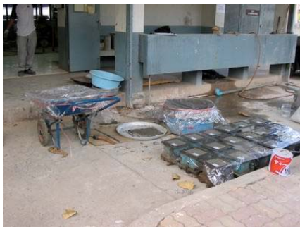
รูปที่ 7 การเก็บก้อนตัวอย่างและการหาค่า Slump loss ของคอนกรีตสด
