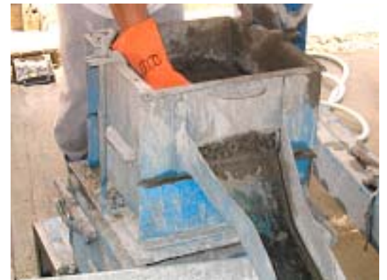
รูปที่ 5 แสดงการเตรียมคอนกรีตสำหรับทดสอบระยะเวลาก่อตัวของคอนกรีตในห้องทดสอบ
