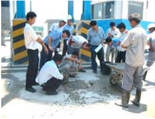
รูปที่ 6 แสดงการทดลองส่วนผสมคอนกรีตที่โรงงาน มีการตรวจสอบค่ายุบตัวเริ่มต้น (Initial Slump)
