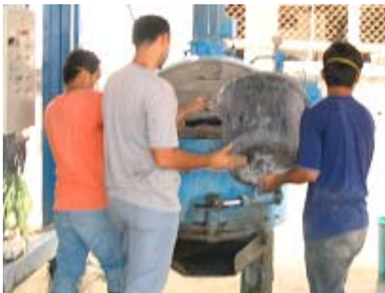
รูปที่ 3 แสดงการทดลองส่วนผสมคอนกรีตในห้องทดสอบคอนกรีต ศูนย์ทดสอบบางซื่อ
