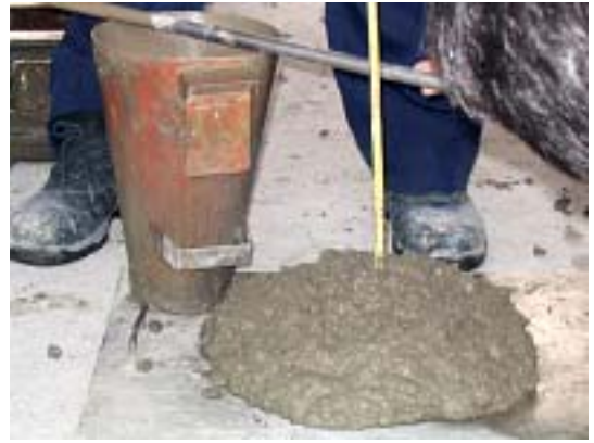
รูปที่ 4 แสดงเนื้อคอนกรีตที่ได้หลังจากปรับส่วนผสมคอนกรีตครั้งแรก
