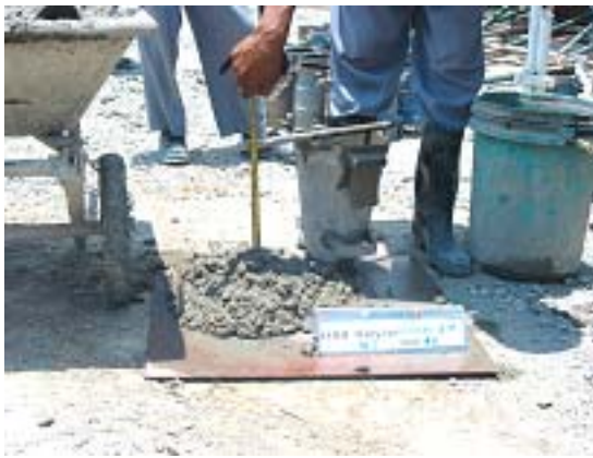
รูปที่ 7 แสดงสภาพเนื้อคอนกรีตก่อนเทลงแบบ ทดลองขนาด 1 ลูกบาศก์เมตร (Big Cube) โดยมีค่า ยุบตัว 19 เซนติเมตร
