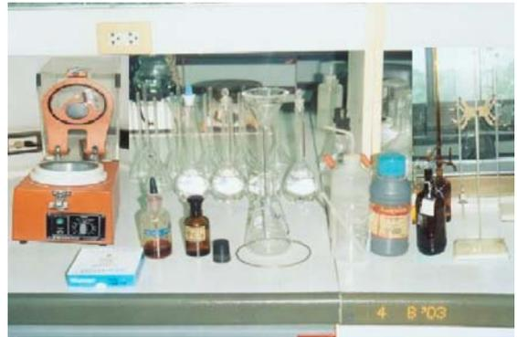
รูปที่ 2 อุปกรณ์ทดสอบคลอไรด์ในห้องปฏิบัติการ
