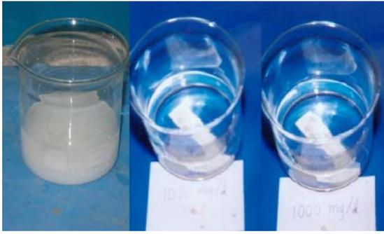
รูปที่ 5 ตะกอนสีขาวขุ่นที่เกิดขึ้นกับสารละลาย  $Cl^-$  แต่ ละความเข้มข้น
