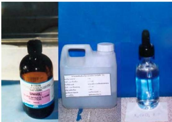
รูปที่ 3 สารละลายที่ใช้ทดสอบคลอไรด์ภาคสนาม
