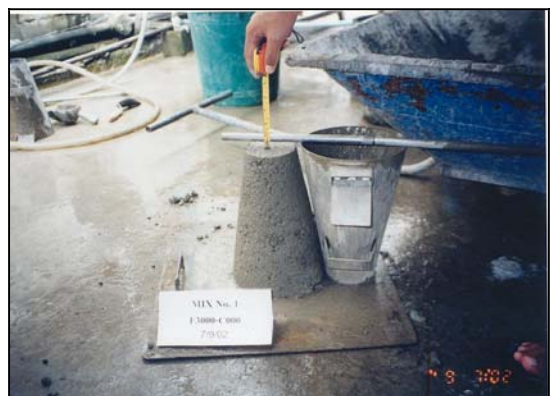
รูปที่ 6 แสดง การทดสอบหาค่ายุบตัวเริ่มต้น และที่เวลาต่าง ๆ เพื่อหาค่าที่เหมาะสม เพื่อเลือกส่วนผสมที่เหมาะสมในการใช้งาน
