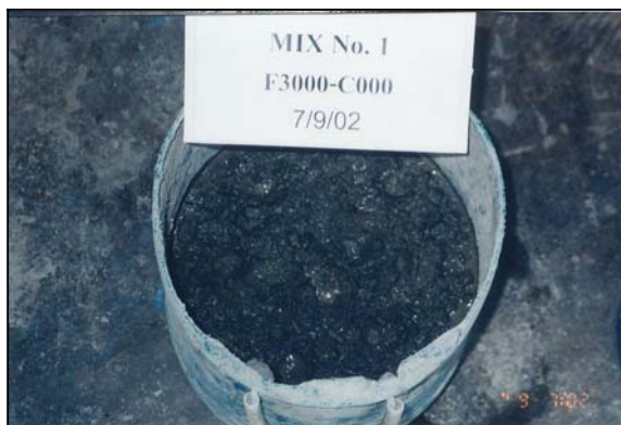
รูปที่ 5 แสดง การทดสอบหาการเฝิ้มของคอนกรีต โดยกำหนดน้ำและน้ำยา Superplasticizer ที่ปริมาณต่าง กัน
