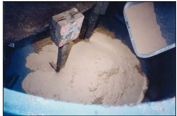
รูปที่ 5 แสดงวิธีการผสมแบบที่ 2 โดยการคลุก เคล้าฝุ่นกับทรายในเครื่องผสมก่อน
