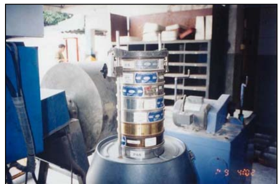
รูปที่ 1 แสดงการร่อนทรายผ่านตะแกรงเพื่อแยกเอาส่วนละเอียดของทรายขนาดต่าง ๆ
