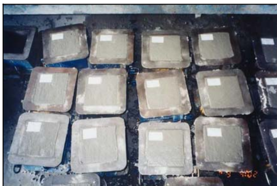
รูปที่ 8 แสดงการเก็บตัวอย่างคอนกรีตเพื่อทดสอบกำลังอัด
