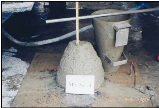
รูปที่ 6 แสดงการทดสอบค่ายุบตัวของคอนกรีต
