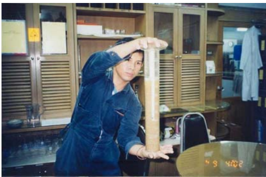
รูปที่ 9 แสดงวิธีการทดสอบการตกตะกอนของทรายอย่างง่ายเพื่อกำหนดปริมาณส่วนละเอียดเพื่อเป็นมาตรฐานในการปฏิบัติที่โรงงาน ซึ่งอยู่ในระหว่างพัฒนาวิธีการของหน่วยงานพัฒนาผลิตภัณฑ์
