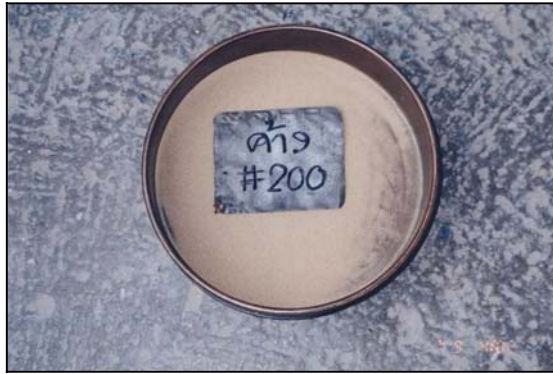
รูปที่2 แสดงทรายผ่านตะแกรงเบอร์100 และค้ำ ตะแกรงเบอร์ 200 ( ทรายขนาดระหว่าง 150 \mu\text{m} - 75 \mu\text{m} )
