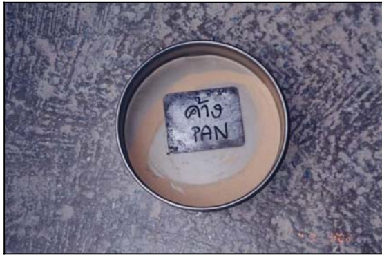
รูปที่3 แสดงทรายผ่านตะแกรงเบอร์200หรือฝุ่นทราย ( ทรายขนาดเล็กกว่า 75 \mu\text{m} )
