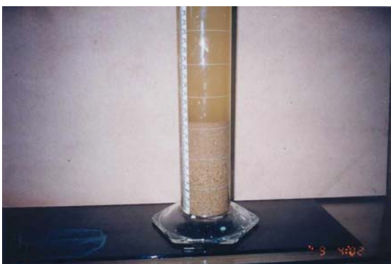
รูปที่ 10 แสดงการตกตะกอนของทรายแต่ละขนาด
