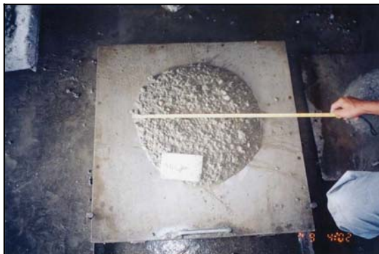
รูปที่ 7 แสดงการทดสอบการไหลตัวของคอนกรีต
