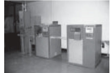
รูปที่ 2-2 เครื่องมืออัตโนมัติสำหรับการควบคุมคุณภาพปูนซีเมนต์ในระหว่างกระบวนการผลิต
