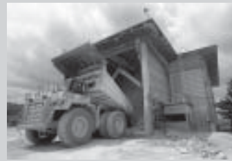
ฉ) การเทใส่เครื่องย่อยหิน
