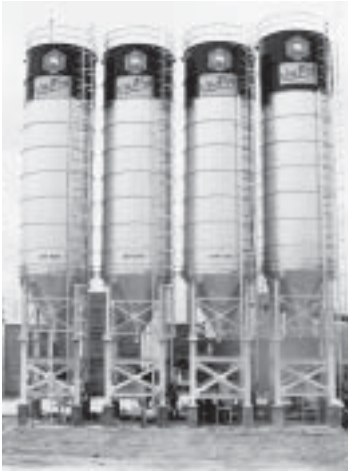
รูปที่ 2-27 การเก็บรักษาปูนซีเมนต์ผงไว้ในไซโลปูนซีเมนต์
