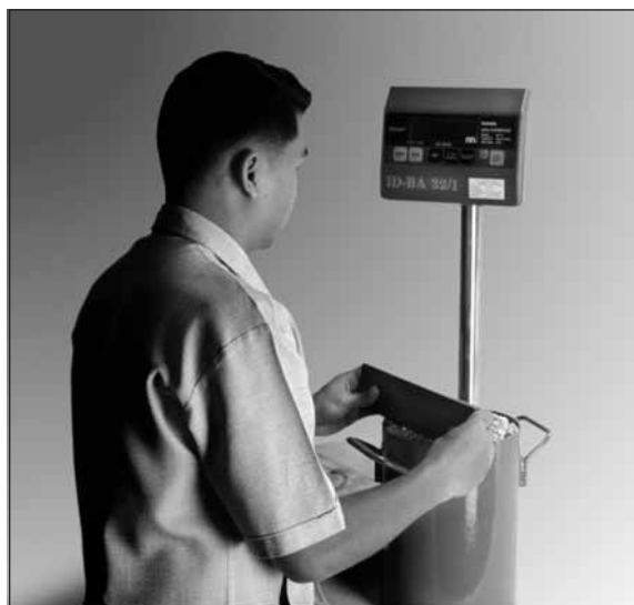
รูปที่ 6 การปาดผิวหน้าตัวอย่างให้เรียบเสมอขอบถึง
