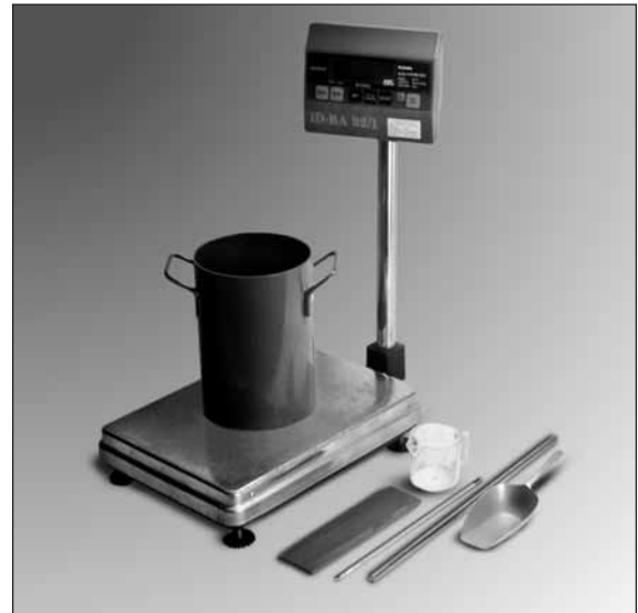
รูปที่ 4 อุปกรณ์ทดสอบหาหน่วยน้ำหนักและช่องว่างในมวลรวม
