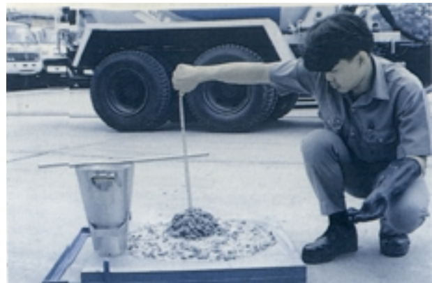
รูปที่ 7.3 คอนกรีตที่ออกแบบไม่ถูกต้องจะแยกตัว
