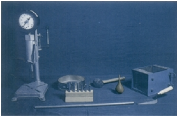
รูปที่ 7.13 อุปกรณ์ทดสอบเวลาการก่อตัวของคอนกรีต
