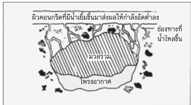
รูปที่ 13.3 โพรงอากาศได้มวลรวมและช่องทางที่น้ำไหลขึ้นสู่ด้านบนซึ่งส่งผลให้กำลังของคอนกรีตผันแปรไป
