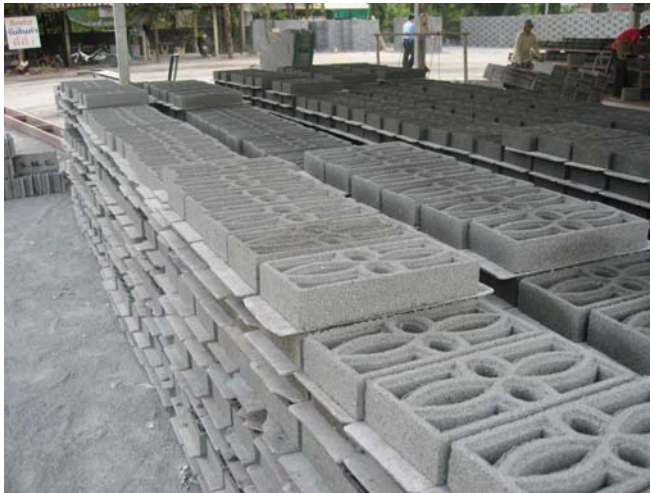
รูปแสดงตัวอย่างของบล็อกชนิด Screen Block ประเภทต่างๆ
