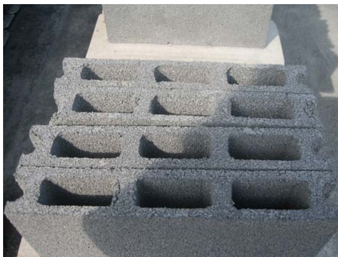
รูปแสดงรายละเอียดของบล็อกชนิดรับน้ำหนัก และไม่รับน้ำหนัก
