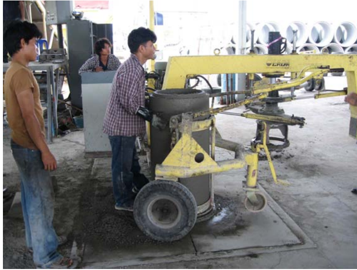
รูปแสดงรายละเอียดของการเคลื่อนย้ายท่อคอนกรีต
