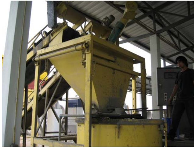
รูปแสดงรายละเอียดการผสมคอนกรีตผ่านเครื่องผสมคอนกรีต
