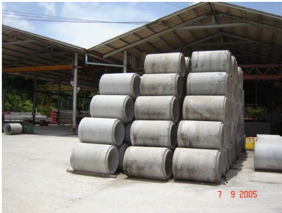
รูปแบบท่อระบายน้ำคอนกรีตปากลิ้นราง ชนิดเสริมเหล็ก และไม่เสริมเหล็ก
