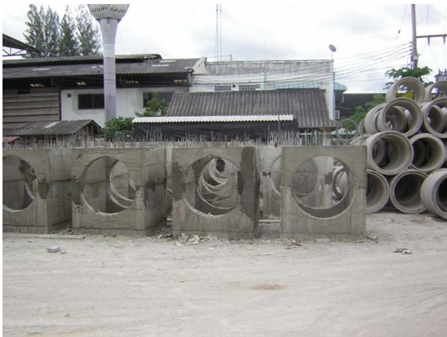
รูปแบบท่อระบายน้ำคอนกรีตรูปสี่เหลี่ยม
