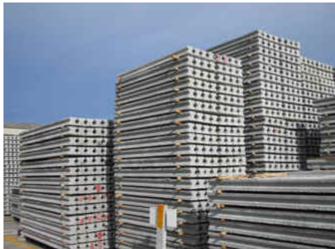
รูปแสดงเสาเข็มคอนกรีตหน้าตัดรูปตัวไอ
