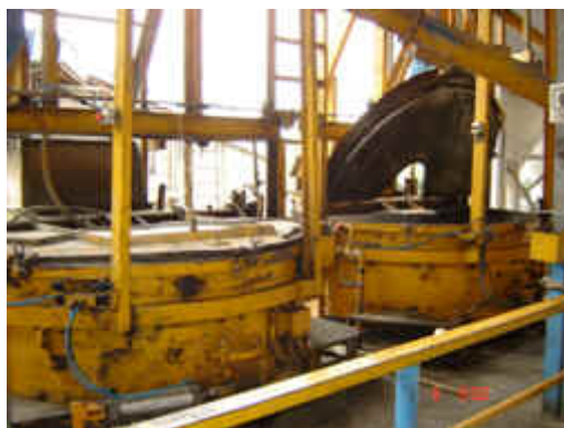
ภาพแสดงเครื่องผสมคอนกรีตชนิด Pan Type
