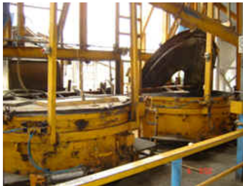
ภาพแสดงเครื่องผสมคอนกรีตชนิด Pan Type
