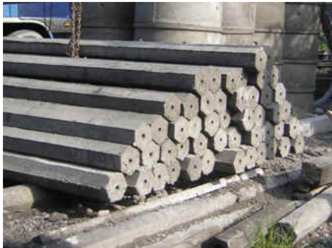
รูปแสดงตัวอย่างเสาเข็มคอนกรีตหน้าตัดรูปหกเหลี่ยมกลวง
