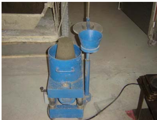
ภาพแสดงการดำคอนกรีตในกรวย Slump
