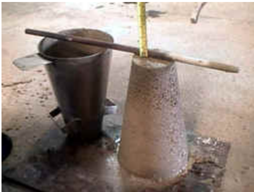
คอนกรีตชนิด No Slump
