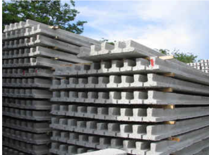
รูปแสดงเสาเข็มคอนกรีตหน้าตัดรูปตัวที
