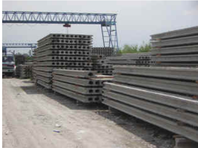
รูปแสดงเสาเข็มคอนกรีตหน้าตัดตัวไอชนิด Long Span
