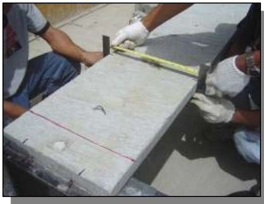
รูปแสดงการวัดความกว้างของชิ้นส่วนคอนกรีต ภาคตัดขวางกลาง
