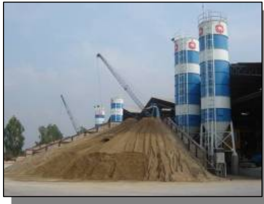
รูปแสดงไซโลปูนซีเมนต์ผงที่ใช้ในการผลิต
