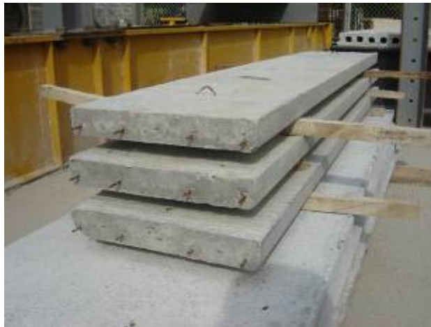
รูปแสดงแผ่นพื้นคอนกรีตสำเร็จรูปอัดแรงชนิดตัน
