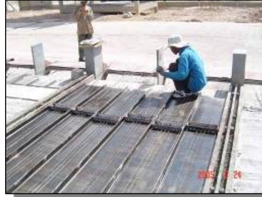
2. ทำการวางลวดตามแผนผลิต
