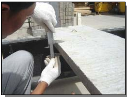
รูปแสดงการวัดความหนาของชิ้นส่วนคอนกรีต ภาคตัดขวางกลาง
