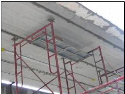
รูปแสดงแท่นรองรับ Dial Gauge ที่ได้ห้อง แผ่นในการปฏิบัติหน้างาน
