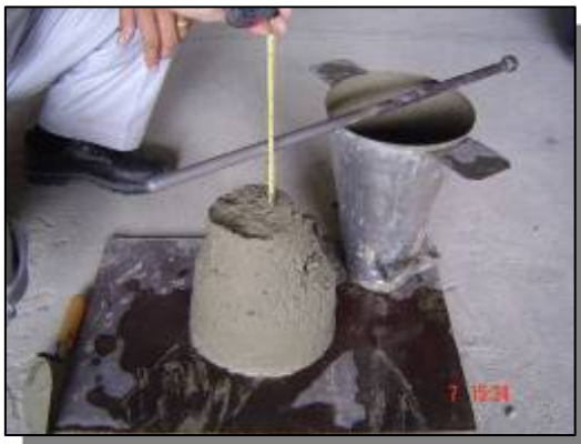
รูปแสดงคอนกรีตแบบ Slump
