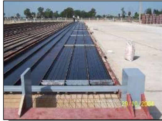
4. ทำการแบ่งระยะการตัดด้วยตัวแบ่ง
