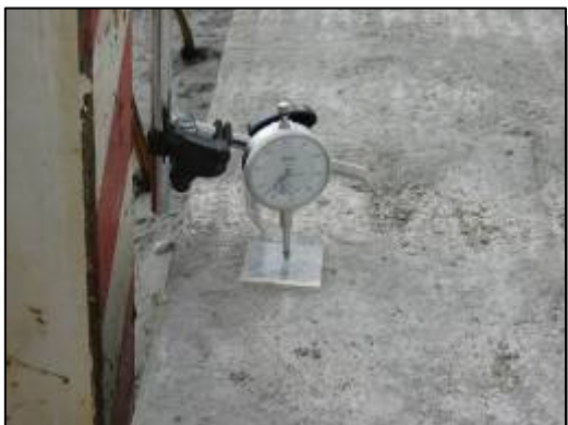
รูปแสดงการติดตั้ง Dial Gauge ที่ริมแผ่น ด้านท้าย
