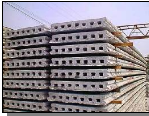
รูปแสดงตัวอย่างแผ่นพื้นคอนกรีตสำเร็จรูปอัดแรงแบบกลวง (HC8x60 cm.)
