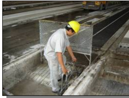
4. ทำการดึงลวดให้ได้แรงดึงตามที่กำหนด (70%)
