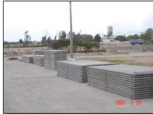
4. การจัดวางไม้หมอนต้องตรงกัน
