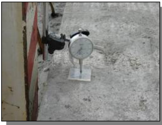
รูปแสดงการติดตั้ง Dial Gauge ที่ริมแผ่น ด้านท้าย
