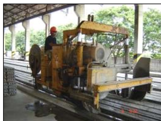
2. ตัดแผ่นพื้นด้วยเครื่องตัดตามความยาวที่วัดไว้
