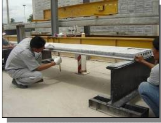
รูปแสดงการวัดความโก่งของชิ้นคอนกรีต
