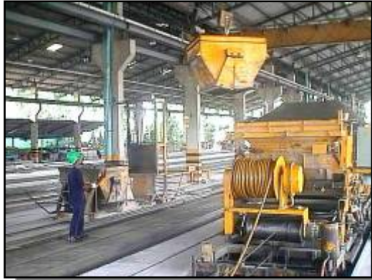
1. นำคอนกรีตป้อนเข้าสู่เครื่องผลิต
