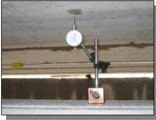
รูปแสดงการติดตั้ง Dial Gauge ใต้ท้องแผ่น
