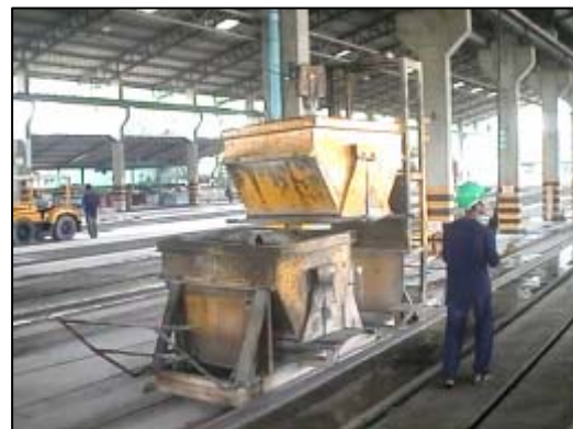
6. นำคอนกรีตไปป้อนเข้าสู่แบบผลิตหรือเครื่องผลิต
