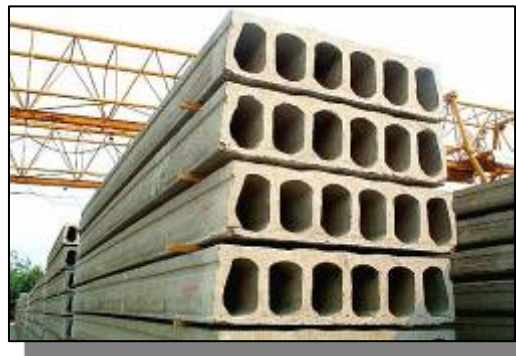
รูปแสดงตัวอย่างแผ่นพื้นคอนกรีตสำเร็จรูปอัดแรงแบบกลวง (HC30x120 cm.)
