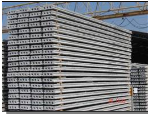
รูปแสดงตัวอย่างแผ่นพื้นคอนกรีตสำเร็จรูปอัดแรงแบบกลวง (HC8x30 cm.)
