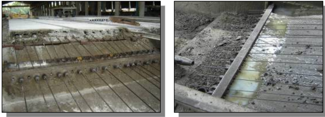
รูปแสดงแผงยึดลวดที่แทนผลิตแผ่นพื้นคอนกรีตสำเร็จรูปอัดแรงแบบกลวง
