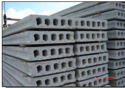
รูปแสดงตัวอย่างแผ่นพื้นคอนกรีตสำเร็จรูปอัดแรงแบบกลวง (HC15x60 cm.)
