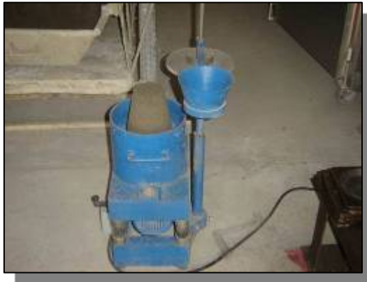
รูปแสดงการต้ำคอนกรีตในกรวย Slump
