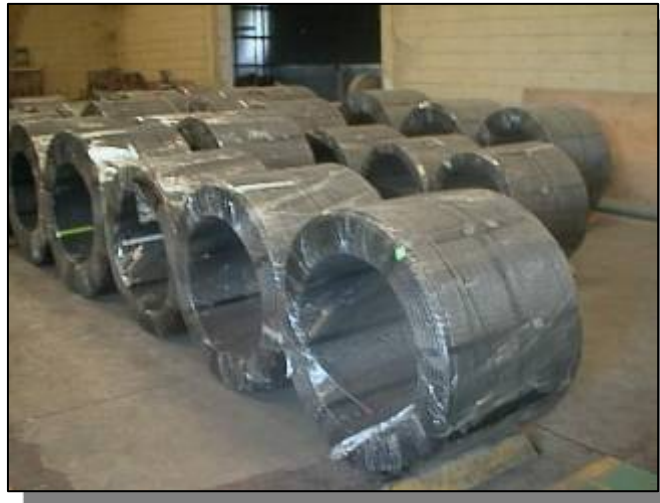
รูปแสดงลวดเหล็กตีเกลียวแรงดึงสูงที่ใช้ในการผลิต
