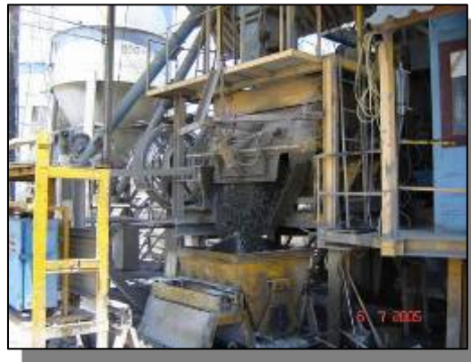
รูปแสดงเครื่องผสมคอนกรีตแบบ Drum Type
