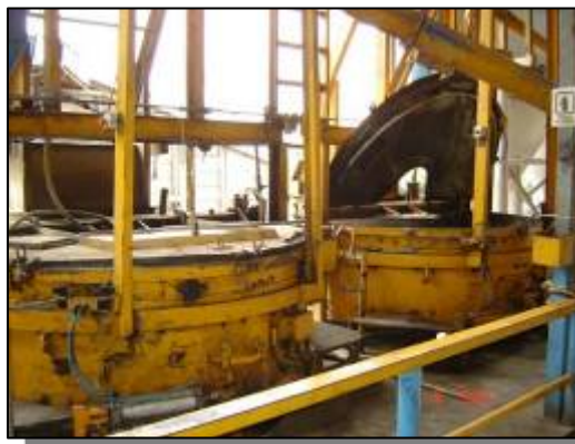
รูปแสดงเครื่องผสมคอนกรีตแบบ Pan Type
