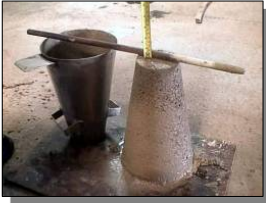
รูปแสดงคอนกรีตแบบ No Slump
