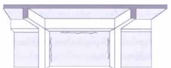
รูปที่ 3 รอยแตกแนวตั้งที่ผนังชิดขอบเสา ถ้าความกว้างของรอยแตกมีขนาดเท่ากันโดยประมาณตลอดความยาว ส่วนมากเกิดจากการหดตัวของปูนฉาบ และไม่มีเหล็กเสริมจากเสาเพื่อยึดผนัง
