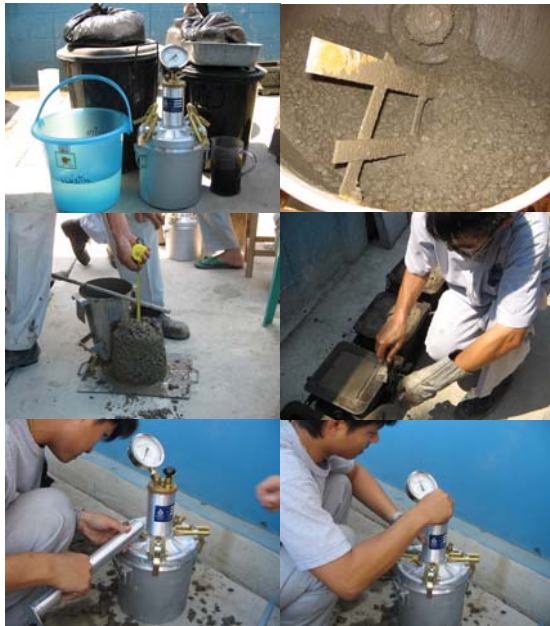
รูปที่ 4: รูปแสดงการทดสอบส่วนผสมคอนกรีต พร้อมทำการทดสอบหาปริมาณฟองอากาศในคอนกรีตสดที่อายุ 30 นาที
