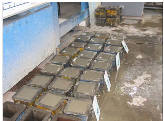
รูปที่ 14 การทดสอบกำลังรับแรงอัด (Compressive Strength Test) ก่อนปูนตัวอย่างรูปทรงลูกบาศก์ตามมาตรฐาน BS 1881
