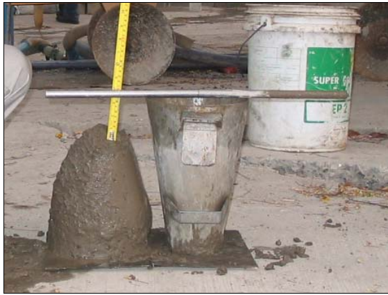
รูปที่ 15 การทดสอบการสูญเสียค่าการยุบตัว (Slump Loss) ของคอนกรีตตามมาตรฐาน ASTM C143
