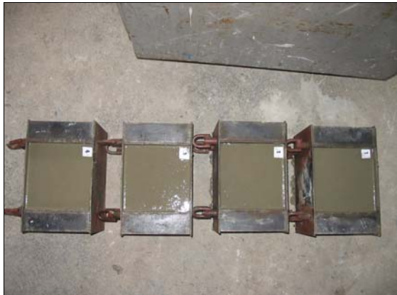
รูปที่ 12 การทดสอบหาระยะเวลาการก่อตัวของคอนกรีตตามมาตรฐาน ASTM C403
