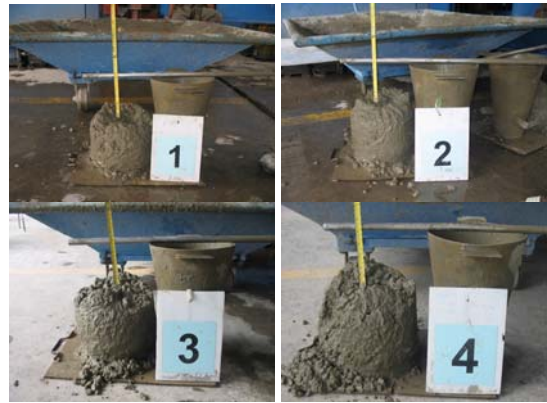
รูปที่ 13 การทดสอบการสูญเสียค่าการยุบตัว (Slump Loss) ของคอนกรีตตามมาตรฐาน ASTM C143
