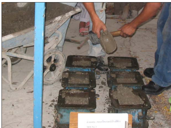
รูปที่ 17 การทดสอบกำลังรับแรงอัด (Compressive Strength Test) ก่อนปูนตัวอย่างรูปทรงลูกบาศก์ตามมาตรฐาน BS 1881
