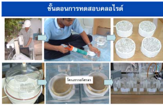
รูปที่ 6 แสดงวิธีการทดสอบ Rapid Chloride Penetration
