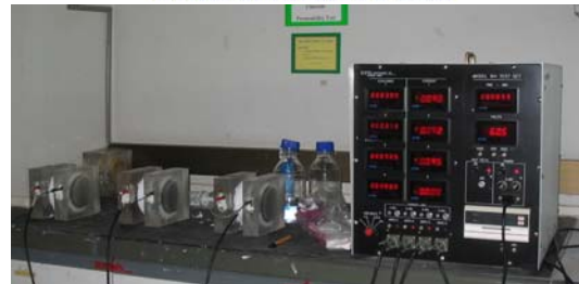
รูปที่ 3 แสดงวิธีการทดสอบ Rapid Chloride Penetration และ ชุดอุปกรณ์
