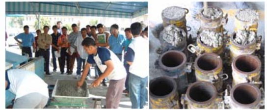
รูปที่ 10 แสดงการทดลองส่วนผสมคอนกรีตในห้องทดลอง นักศึกษามหาวิทยาลัยราชภัฏจังหวัดภูเก็ต ภาควิชาเทคโนโลยีการก่อสร้าง
